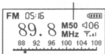
Для выбора желаемого диапазона в режиме радио используйте кнопки **FM**, **AM** или **SW**. Текущий диапазон будет отображаться в левом верхнем углу экрана. В диапазоне SW кнопка **SW** служит для выбора поддиапазона.
